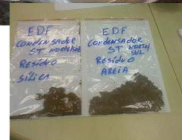
*"El cambio de limpieza de Hidrolavado a la tecnología CONCO proporcionado una limpieza eficaz mediante la eliminación de la arena y la totalidad de los depósitos de sílice de las paredes del tubo". (Nelson Cansanção Neto, Expander)*
